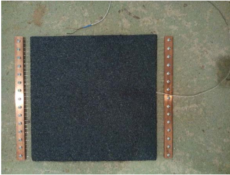
Obr. 5 Cílené vyhřívání vzorků pomocí elektrické odporové mřížky
